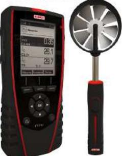
VT210 + sonda SH100 (sonda a elica Ø100 mm per velocità, portata e temperatura)
