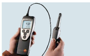
Terminale della sonda umidità collegato all'impugnatura via cavo
