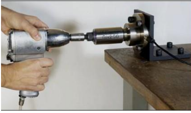
DTR2 + TRF torsiometro STATICO. Sistema per la taratura di avvitatori a massa battente
